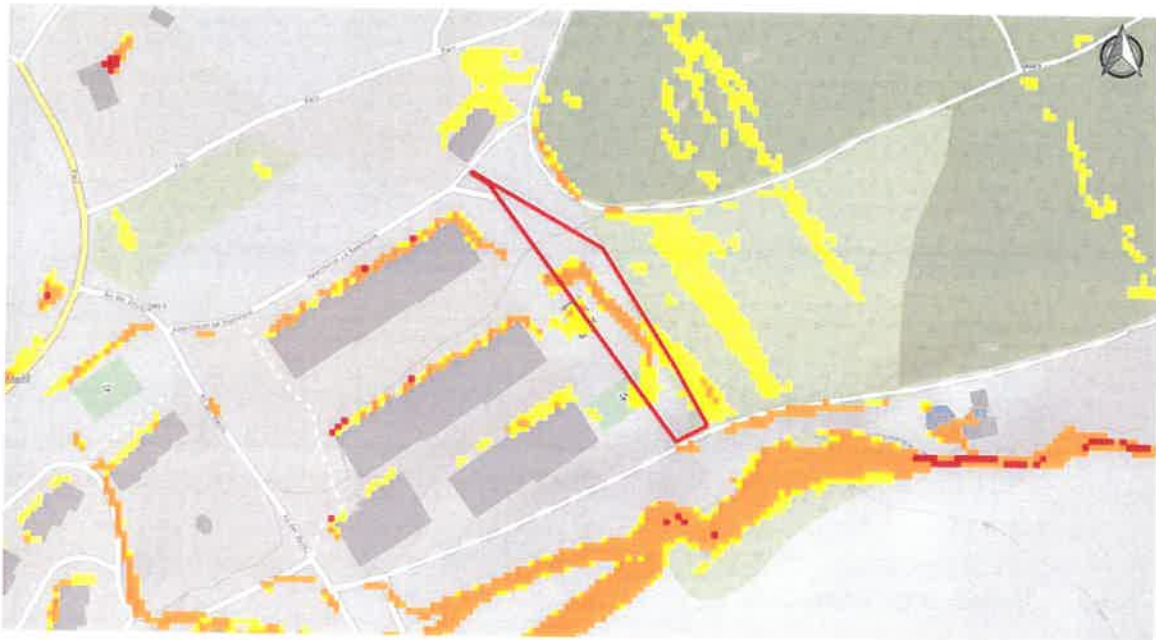
Abbildung 26: Starkregengefahrenezonen im Plangebietsbereich. Quelle: http://www.geoportail.lu
