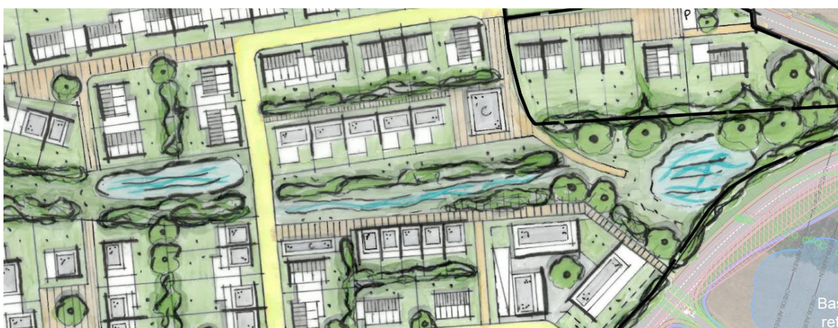
Abbildung 54: Ausschnitt aus dem Baukonzept des Wohnviertels. Die geplanten offenen Regenrückhaltegräben sind entlang der zentralen Grünachse vorgesehen. Quelle: CO3 2023
